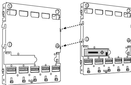
Conexión eléctrica de dos puentes por medio del puente UAH-001
