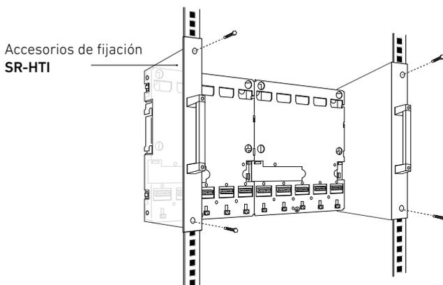
Fijación de los módulos en la base soporte
