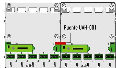
Fijación de dos bases BACK-500 para instalación de la cabecera en rack 19"
